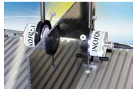
Berührungslose Online-Prüfung durch Einkoppelung von Ultraschall. Bild: IS-LINE
