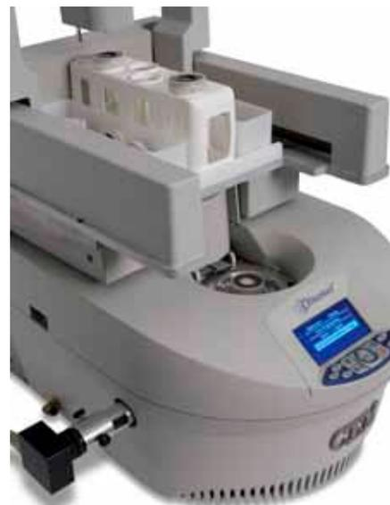
kammer kann jedes beliebige Reagenzienvolumen (1 ml, 10 ml oder bis zu 100 ml) eingesetzt werden. Es können eine Vielzahl von Druckbehältern sowie auch klassische Rundkolben verwendet werden.
