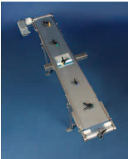
ner Rahmenausparung für eine von unten installierte Leuchte. Zentrale Anforderung war dabei die exakte Erkennung der zufälligen Positionierung des Stückgutes, um den reibungslosen Zugriff des Roboterarms sicherzustellen.
