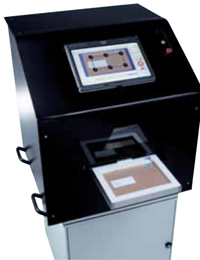
T-Cognition identifiziert verschiedenste Chemikalien mit Terahertz-Wellen Bild: Hübner
