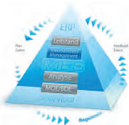
Automatisierungspyramide zeigt Prinzipaufbau in modernen Produktionsumgebungen. Bild: PROXIA
