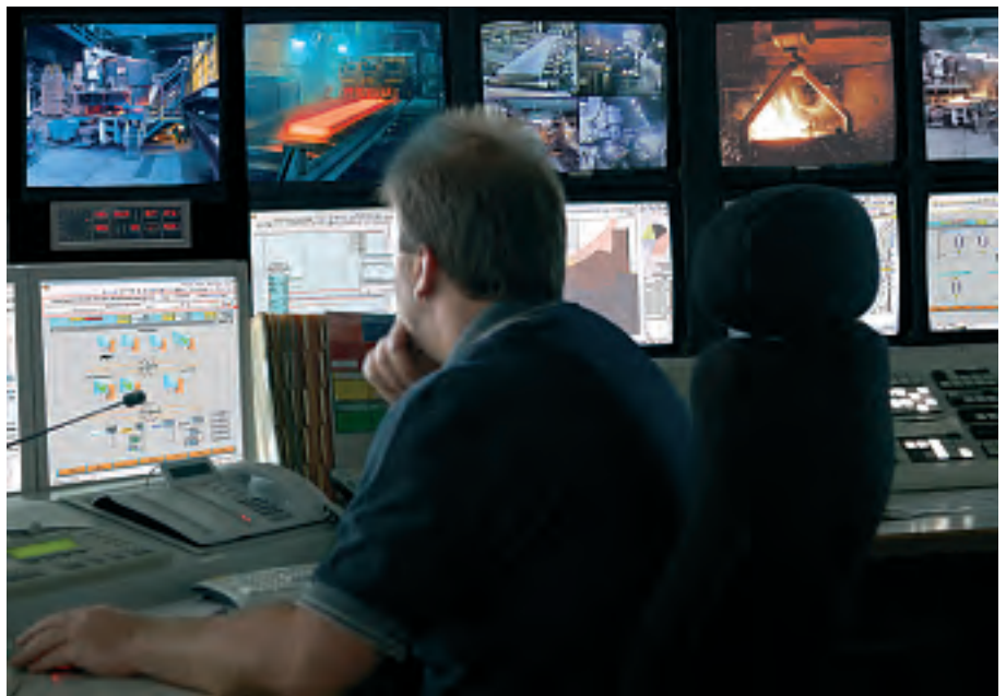
Moderne Leitwarte zur Überwachung und Steuerung von Prozessabläufen.
