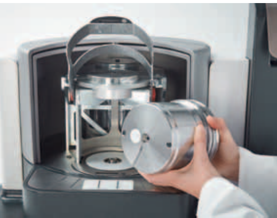
Sicher geführtes Einsetzen des Mahlbechers und Erkennung über RFID-Chip.
