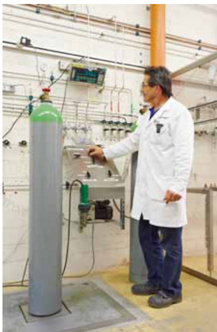
Gravimetrische Herstellung von Gasgemischen.
