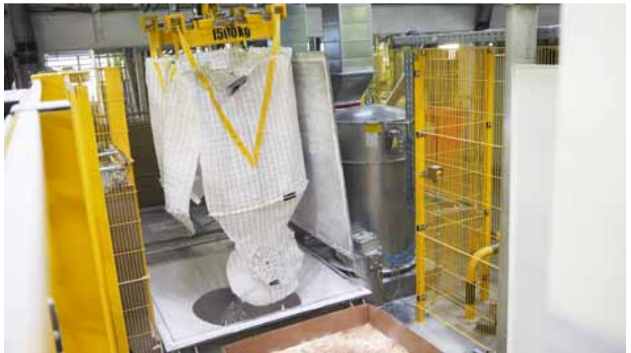
Vollautomatisiert und explosionsgeschützt. Das neue BigBag Entleersystem für die chemische Industrie bei der Entleerung von PVC-Pulver und Titandioxid in einer ATEX-Aufstellungszone 2.
