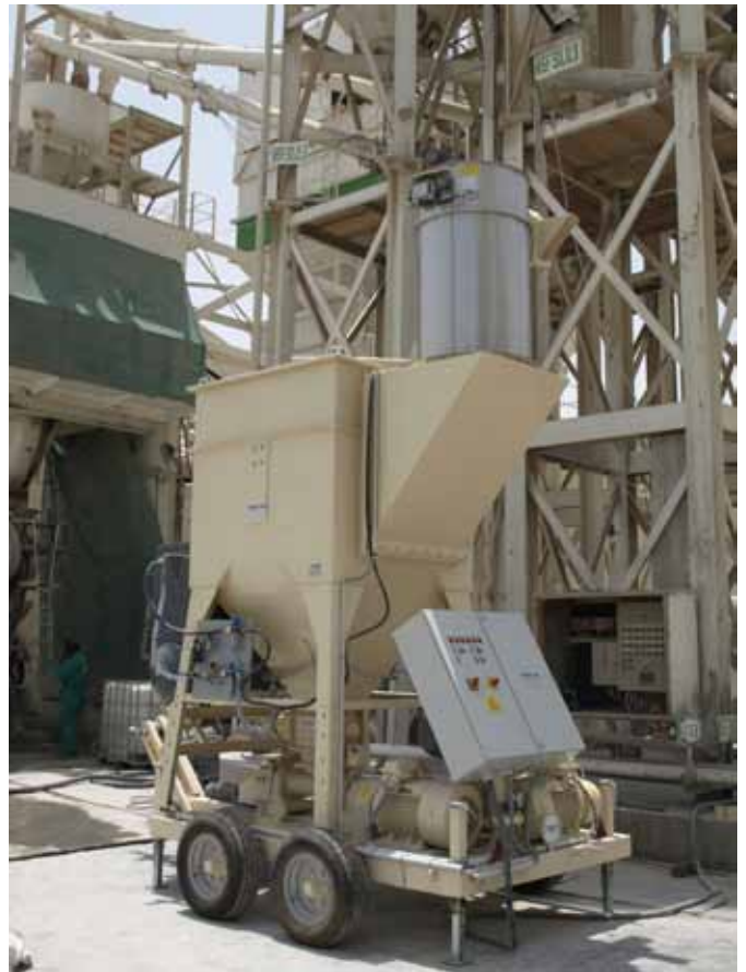
Entleerung von Microsilica zur Zugabe in Drymix Zement: Anlage für den mobilen Einsatz auf Baustellen. Bilder: TELSCHIG
