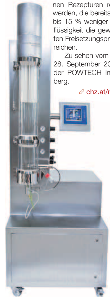
Prozessanlage Romaco Innojet VENTILUS® V 2.5 im Labormaßstab.
