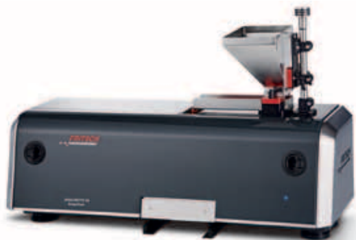
Das neue System zur Trocken-Messung von Pulvern und Schüttgütern.
