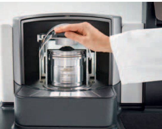
Einfaches Schließen des Bügels, Verspannung erfolgt automatisch per ServoLOCK.
