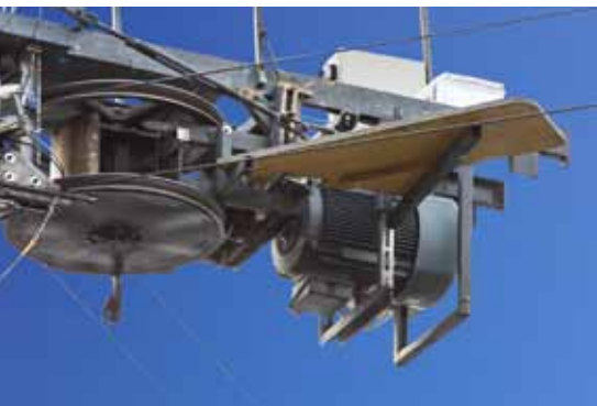
Ein neuer frequenzrichter geregelter Motor lässt die Wakeboarder auch bei voller Auslastung problemlos über das Wasser jagen.
