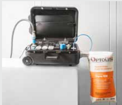
BEUMER bag tester: Mobiles Prüfgerät für Ventilsäcke.
