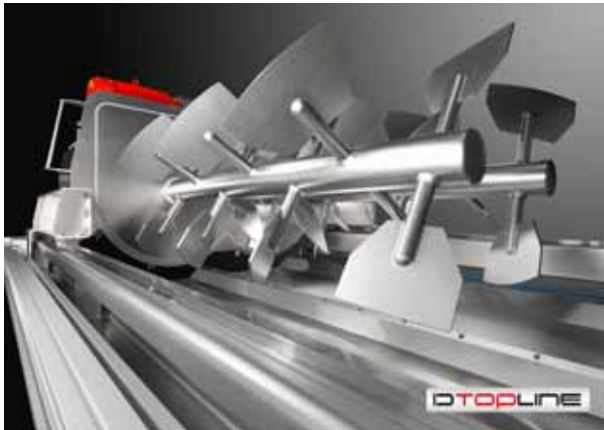
Bewährte Mischtechnik mit neuesten Mischköpfen und Ausführung komplett in RVS.
