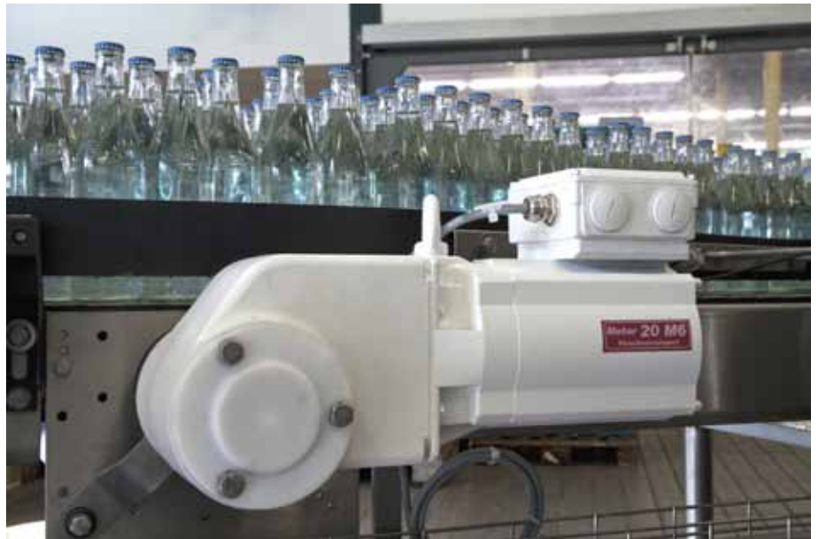
Der Danfoss VLT OneGearDrive ist in Kombination mit den VLT Frequenzumrichter eine sehr effiziente Lösung mit einem Wirkungsgrad von bis zu 90 %. Der OGD wird in einer Baugröße mit drei Standardübersetzungen hergestellt, die praktisch alle Anwendungsfälle abdeckt.
