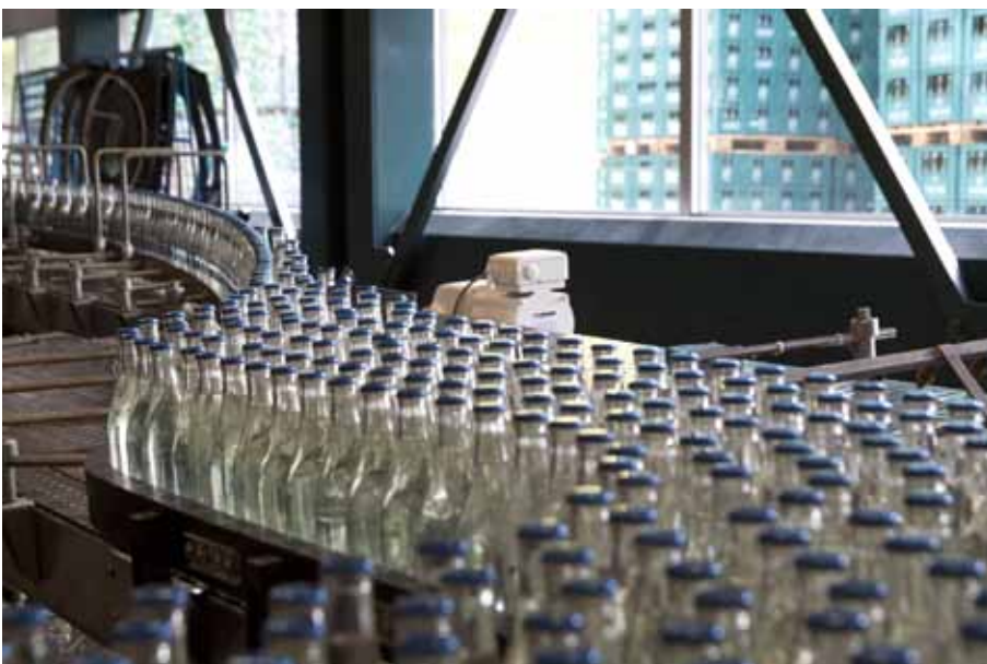
Flaschenanlage in voller Fahrt: Die mit den OGD-Antrieben ausgestattete Anlage fährt sanfter, es tritt weniger Scuffing auf und das Anfahren bzw. das Bremsen erfolgen fast ruckfrei.
