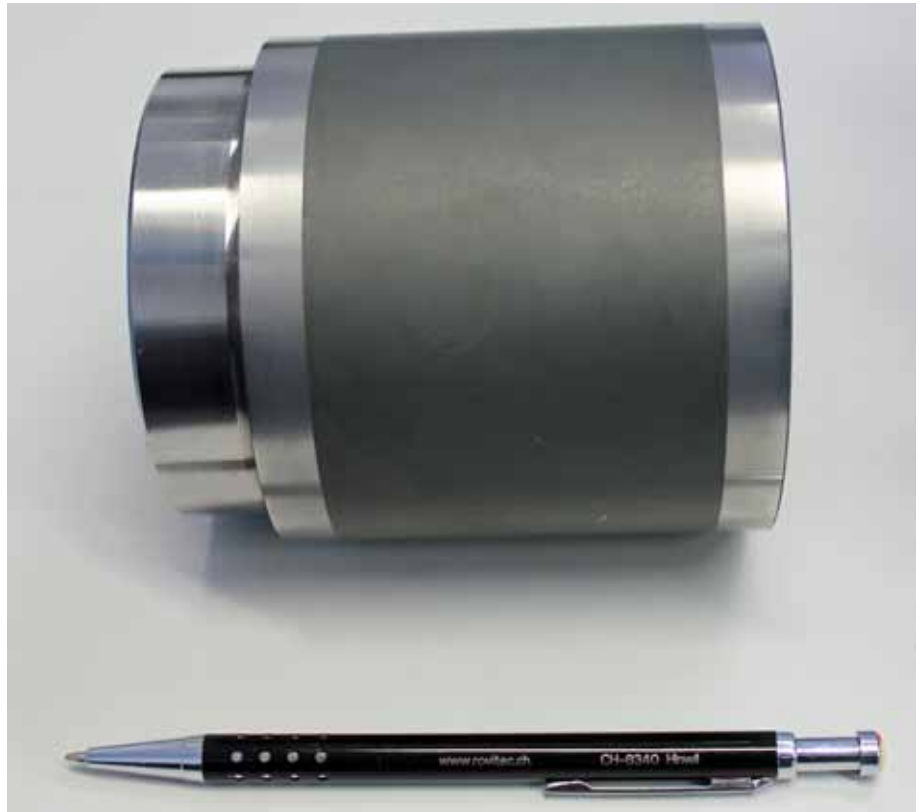
Demonstratorbauteil mit aufgespritzter und auf Maß geschliffener Beschichtung aus hartem, chemisch beständigem und abriebfestem Chromoxid \text{Cr}_2\text{O}_3 .
