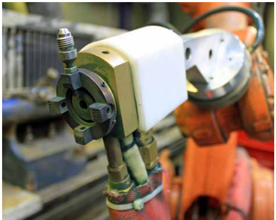
Auf einem Roboterarm montierter Spritzkopf für das atmosphärische Plasmaspritzen. Das Pulver wird dem mittig austretenden Plasmastrahl von oben zugeführt.
