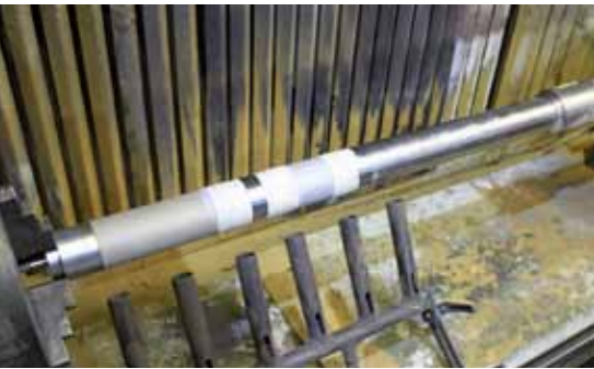
Für Rotationsteile verfügt die Kabine über eine zusätzliche numerisch gesteuerte Drehachse.
