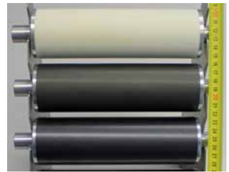
Musterbauteile mit unterschiedlichen keramischen Beschichtungen: Oben Aluminiumoxid Al 2 O 3 , in der Mitte Chromoxid Cr 2 O 3 und unten Titanoxid TiO 2 .
