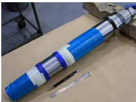
Der zu beschichtende Bereich dieser Welle für einen neuen Hydraulikmotor wurde überdreht, die übrigen Bereiche durch Abkleben geschützt.
