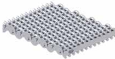
Die poröse Struktur von durchflussoptimierten Tressen ermöglicht die exzellente Durchflussleistung bei Abscheideraten > 6\ \mu\text{m} und findet deshalb große Aufmerksamkeit als Alternative zu Sandfiltern für die maschinelle Wasseraufbereitung.
