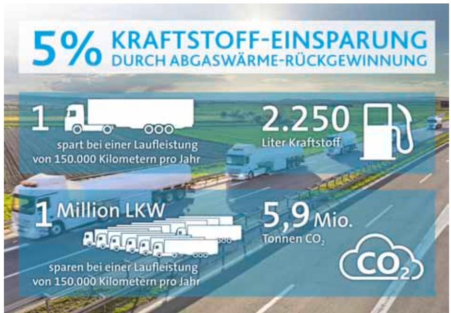
Abwärme ist kein Abfall, sondern kann energetisch die Gesamtbilanz verbessern. Hier im Anwendungsbereich LKW eingänglich dargestellt.
