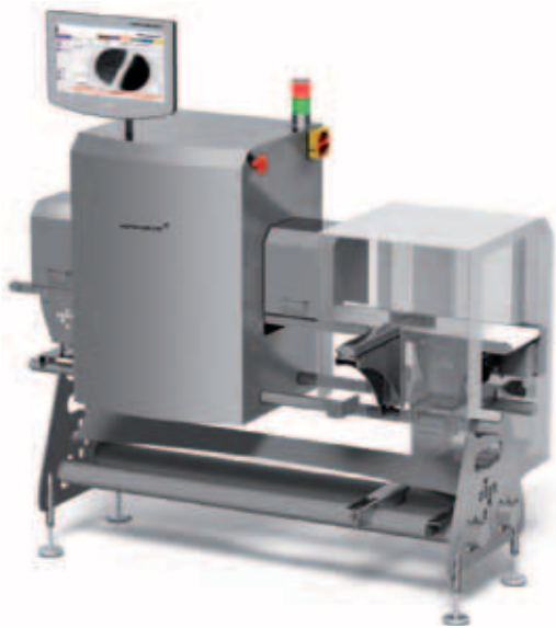
Echtzeitbetrieb erlaubt eine Hochgeschwindigkeitsinspektion von bis zu 600 Stück/Minute.
