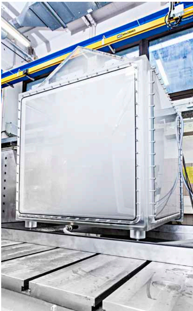
Modulare Versuchseinrichtung für multiaxiale Betriebsfestigkeitsuntersuchungen mit überlagertem Salzsprühnebel im Fraunhofer LBF, Darmstadt.
