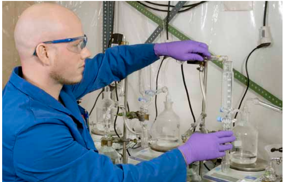
UN Prüfung N.5 Prüfapparatur zur Bestimmung der Gasentwicklung
