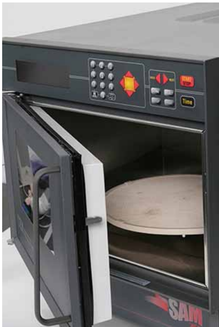
Laborversuche werden durch Mikrowellen-Geräte von CEM – wie hier der SAM 255 – erfahrungsgemäß erheblich beschleunigt.
