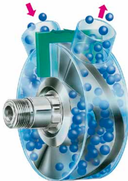
Bei den Sinuspumpen von MasoSine dreht sich ein sinusförmiger Rotor. Dadurch entstehen vier gleich große umlaufende Kammern, die im Ganzen verschoben werden. Fotos: Watson-Marlow Fluid Technology Group
