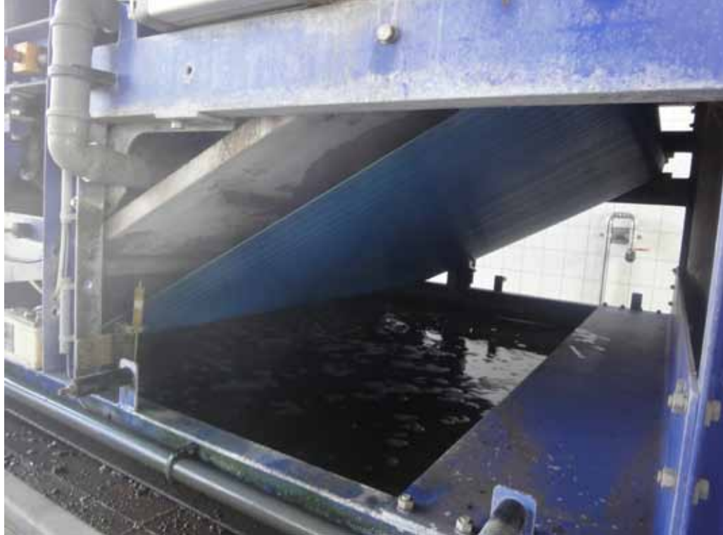
Für schwer entwässerbare Schlämme wird die Bandgeschwindigkeit etwas erhöht und die gesamte Bandbreite des GKD-Siebbands genutzt.
