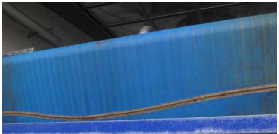
Für das GKD-Band vom Typ 1003 mit integrierter Verschleißanzeige spricht neben der effizienten Entwässerung die zuverlässige PAD-Naht.
