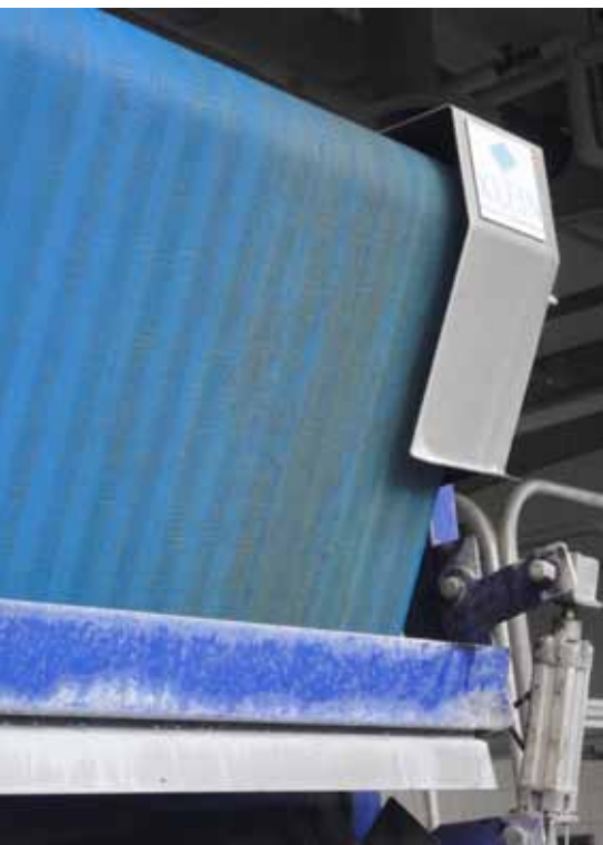
Durch die in dem GKD-Band 1003 integrierte Verschleißanzeige lassen sich Rückschlüsse auf die Standzeiten ziehen.
