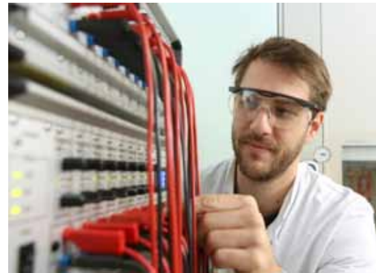
Ein Mitarbeiter der AG Waldvogel bedient eine Screening-Apparatur zur parallelen Elektrolyseoptimierung.
