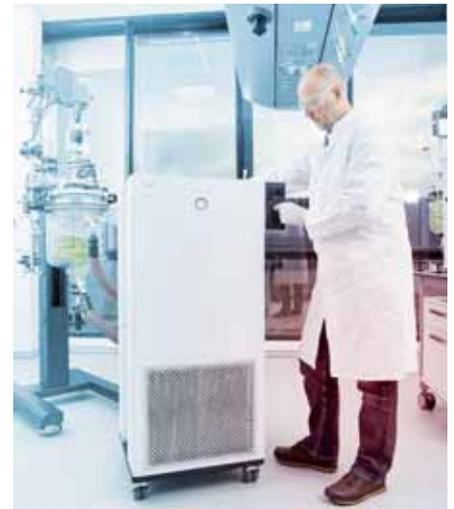
LAUDA Integral Prozessthermostate kommen in einer Vielzahl von Anwendungen zum Einsatz, etwa zur Temperierung von Glasreaktoren in der Chemie, Pharmazie oder Biotechnologie.
