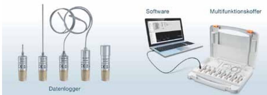
Lösung für hocheffiziente Qualifizierung: Robuste, langlebige und zuverlässige CFR Datenlogger in vier Temperatur- und einer Druckausführung. Der Multifunktionskoffer dient neben der Aufbewahrung und dem sicheren Transport auch dem Programmieren und Auslesen der Logger. Die einzigartige testo 190 CFR Software vervollständigt das Gesamtpaket.
