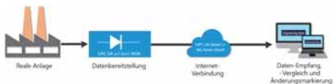
OPC-UA-Verständnis und Webanbindung sind Voraussetzungen für die Kommunikation von Anlage und Engineering-System.
